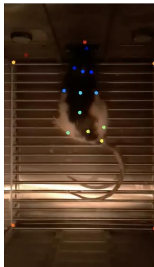
DeepLabCut を用いた訓練中のラットの トラッキングの様子
